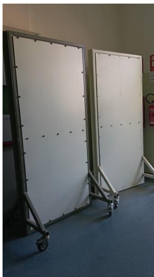
Figura 55. Esempio di schermature in piombo mobili.
