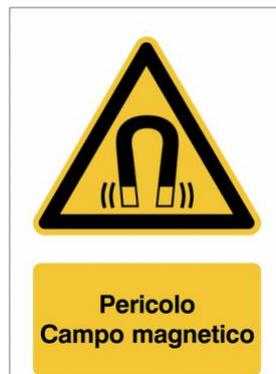
*Figura 65. Pittogramma che avverte della presenza di pericolo di esposizione a campo magnetico.*
