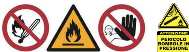
Pittogrammi di pericolo e di divieto per la presenza di gas tecnici.
