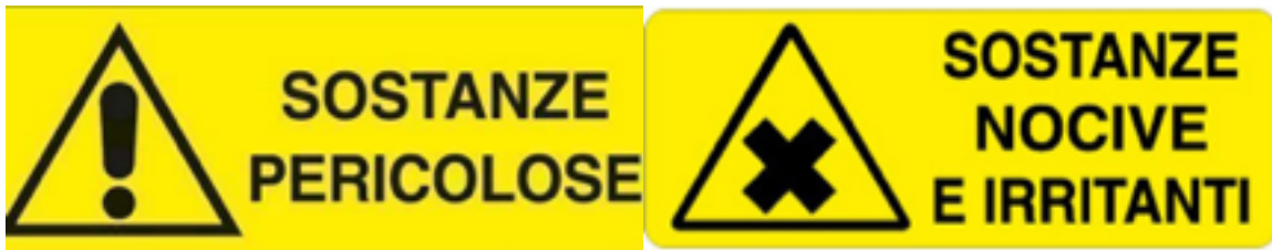
Pittogrammi di pericolo generico. La “X” è stata sostituita dal segnale di pericolo “!”.
